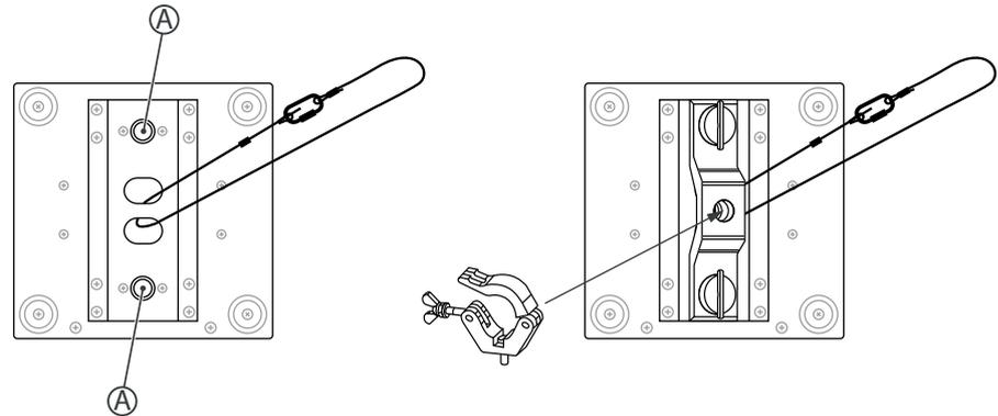
Die Gewinde an der Gehäuseunterseite (A) dienen zur sicheren Montage des mitgelieferten Haltebügels. Daran können Flugadapter (Half Coupler, Trigger Clamps, C-Haken u.ä.) befestigt werden. Das Sicherheitsfangseil wird durch die Aussparungen an der Gehäuseunterseite geführt.
